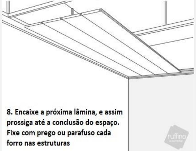
**8. Encaixe a próxima lâmina, e assim prossiga até a conclusão do espaço. Fixe com prego ou parafuso cada forro nas estruturas**
