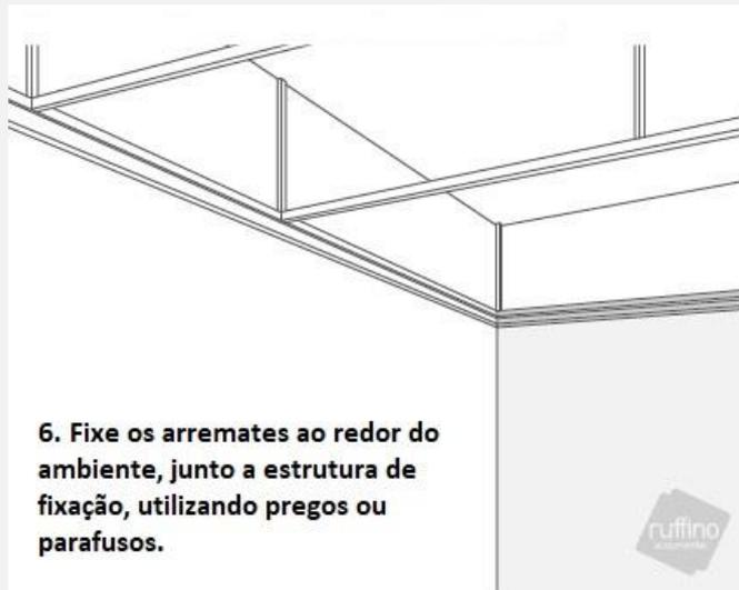
**6. Fixe os arremates ao redor do ambiente, junto a estrutura de fixação, utilizando pregos ou parafusos.**
