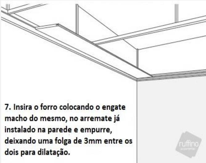
**7. Insira o forro colocando o engate macho do mesmo, no arremate já instalado na parede e empurre, deixando uma folga de 3mm entre os dois para dilatação.**
